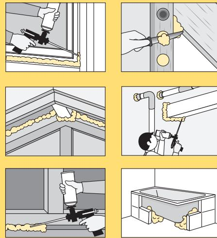
**断熱、結露防止、接着、隙間充填、保温保冷、吸音、緩衝などに幅広く利用できます。**
