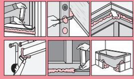
断熱、結露防止、隙間充填、保温保冷、吸音、緩衝などに幅広く利用できます。
