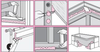
断熱、結露防止、接着、隙間充填、保温保冷、吸音、緩衝などに幅広く利用できます。
